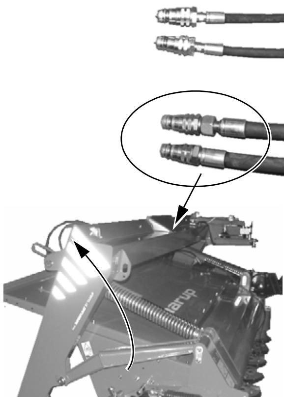
Tilslut maskinens hydrauliske system til traktor eller hydraulisk pumpestation og løft maskinens hovedramme helt op.
