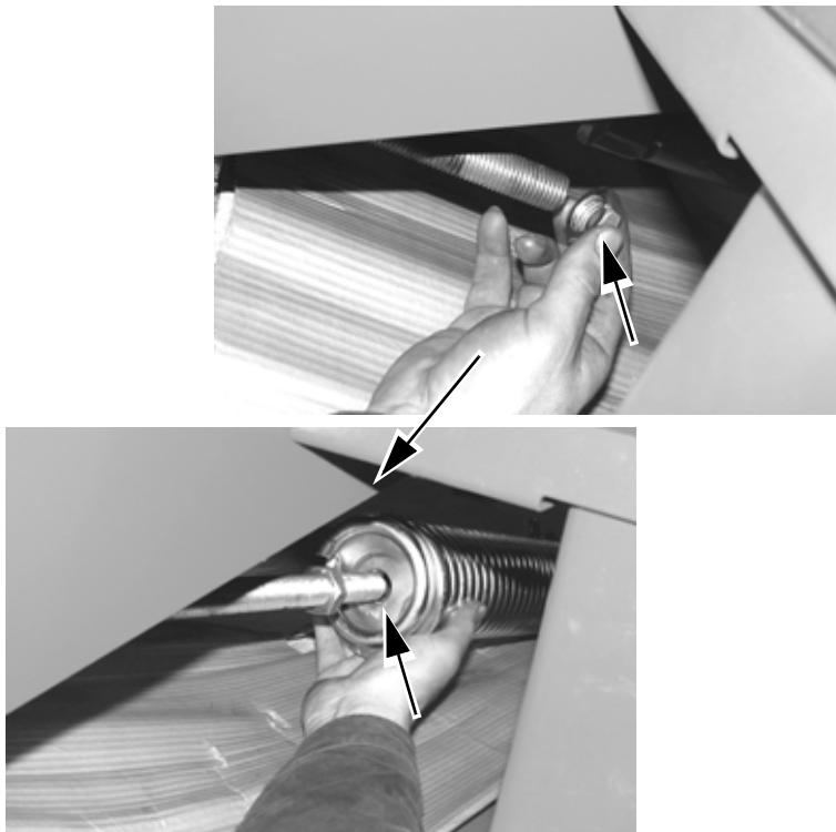
Monter møtrik på spindel og skru spindlen ind i fjederen som vist. Forspænd **IKKE** fjederen.
