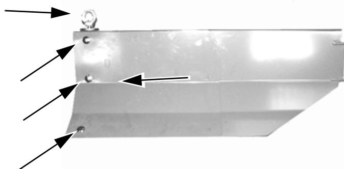
Demonter ringmøtrik og skive på deflektorplade. Demonter de 3 viste bolte og flyt deflektorpladen til den ønskede længde, monter og fastgør bolte.
