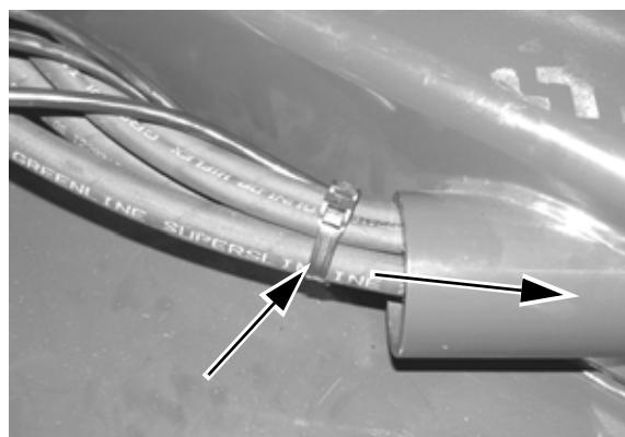
Bind alle hydraulikslanger og ledninger sammen og skrub dem gennem trækstangen.
