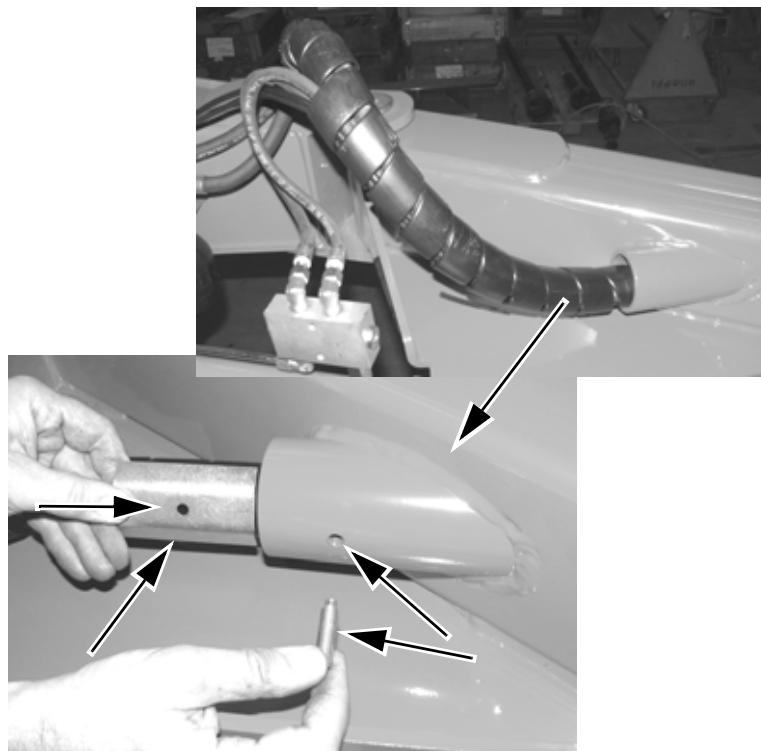
Monter flexslangen omkring alle slanger og ledninger. Skub flexslangen ind i trækstangen som vist. Monter beslaget i røret og spænd Unbraco-bolten til, så flexslangen fastholdes.
