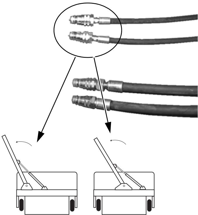
Tilslut hydraulik og stil trækstangen i arbejdsposition.
