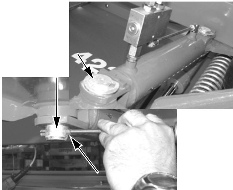
Monter hydraulikcylinder på trækstang.
