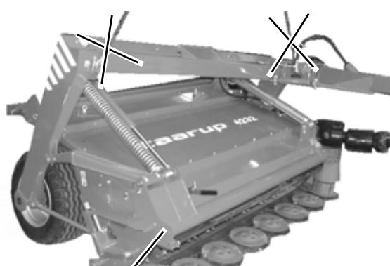
Fjern kranudstyr. Efterspænd og kontroller hjulene er spændt fast med det angivne moment. Kontroller dæktyk.
