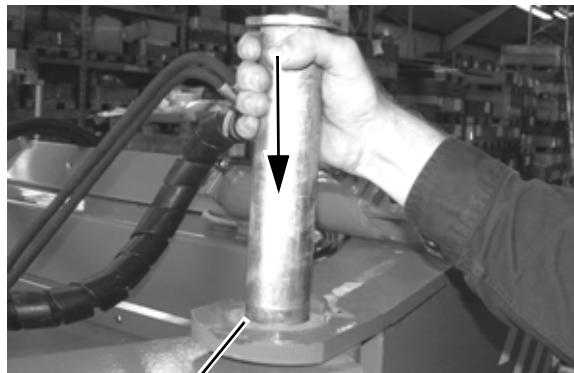
Monter trækstang. Monter skive og låsering på aksel.
