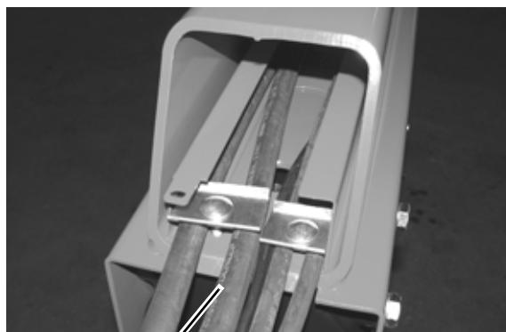
Fastgør beslag for hydraulikslanger og ledninger.
