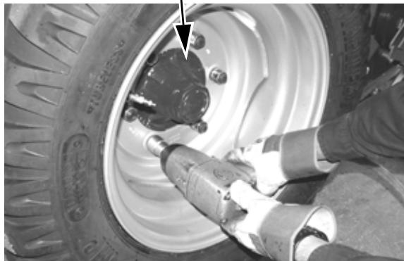
Løft maskinen fri af gulvet og monter hul. Stil maskinen på gulvet.
