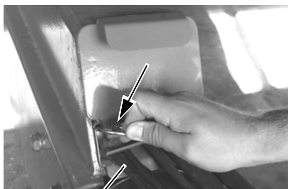
Demonter ringsplit og værktøjskasse. Demonter bolte og beslag.
