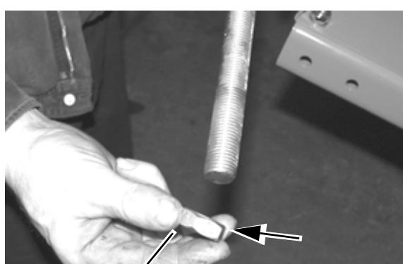
Demonter møtrik på spindel og isæt spindlen som vist.
