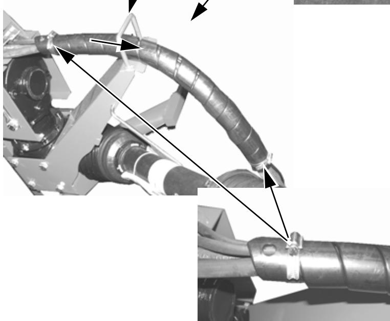
Monter le support pour le porte-tuyau et serrer les boulons du boîtier tête pivotante au couple indiqué. Monter un tuyau flexible autour de tous les tuyaux hydrauliques et les câbles. Monter un dispositif de serrage aux bouts du tuyau flexible et le faire passer par la bride comme montré.
