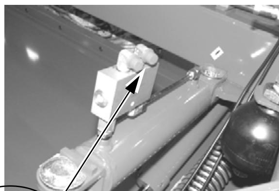
Tilslut hydraulikslanger på trækstangscylinder som vist.
