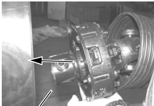
Monter P.T.O. aksel på trækstang.
