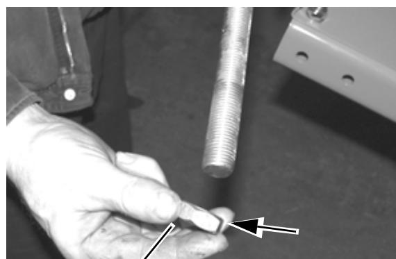
Demonter møtrik på spindel og sæt spindlen som vist.
