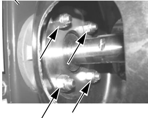
Monter la protection autour de la transmission P.d.F. sur la barre de traction comme montré.
