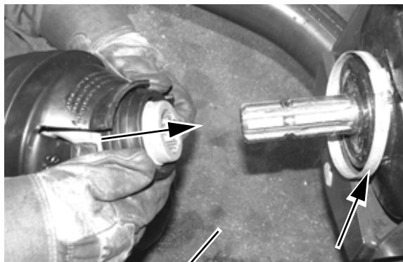
Monter PTO aksel på svinggear.
