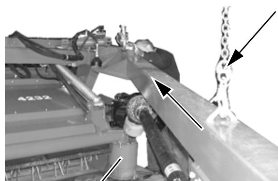
Anvend kranudstyr og løft trækstang i løftebeslag. Monter trækstang.
