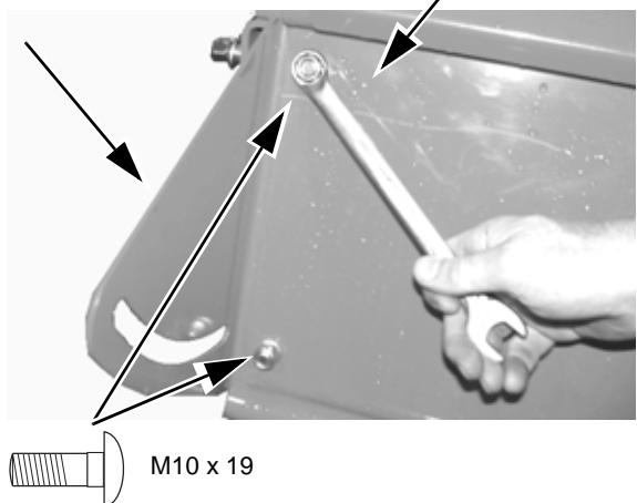
Die Endplatte montieren und sie in das Ende der oberen Platte wie gezeigt schieben. Das Endstück auf der Hinterplatte montieren.
