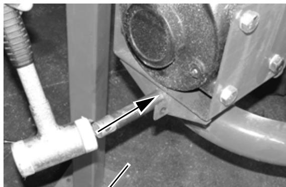
Demonter aksel for træk og monter træk. Fastgør aksel for træk.
