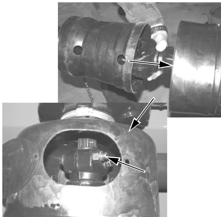
Monter P.T.O. aksel på center gear.
