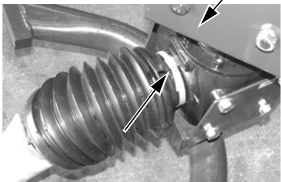
Die Gelenkwelle auf dem Schwenkgetriebe montieren.
