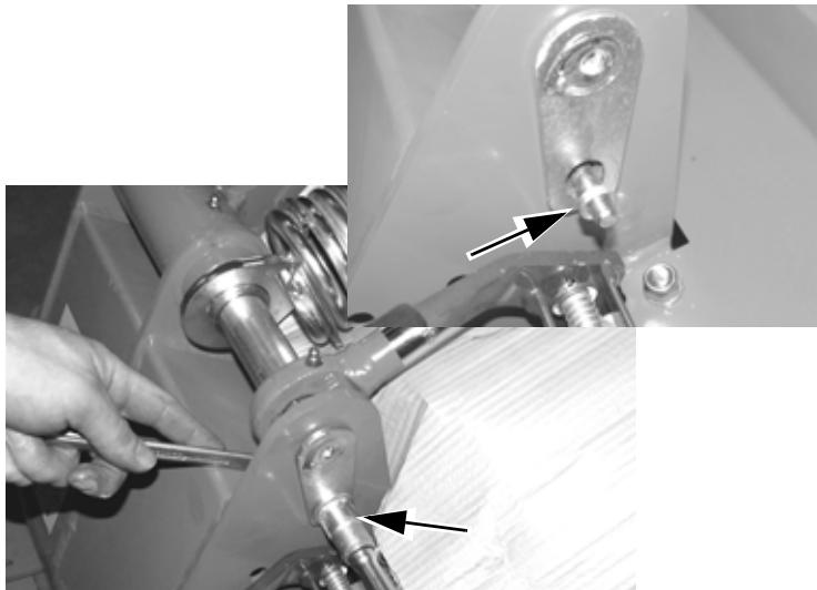
Kontroller at det viste bøs er på plads. Fastgør aksel. Fjern pap fra maskinen.
