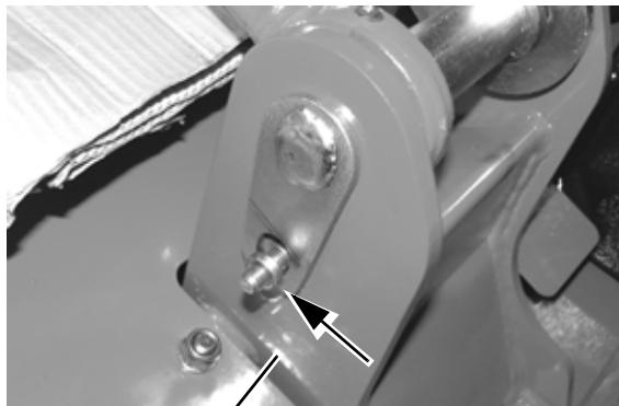
Kontroller at det viste bøs er på plads. Fastgør aksel. Fjern pap fra maskinen.
