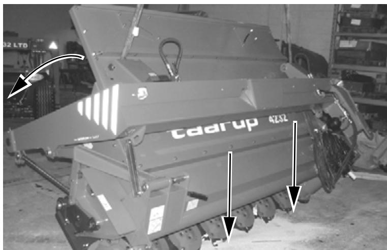
Løft maskinen forsigtig fri af pallen og stil den forsigtigt på gulvet. Demonter kranudstyr.
